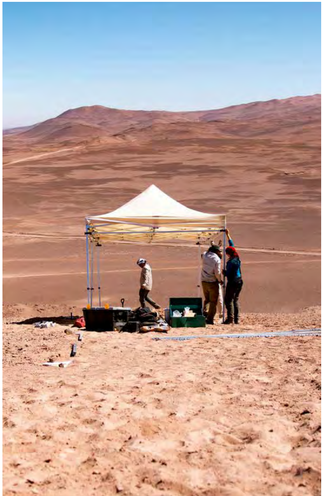
▲ AUS DER FERNE SIEHT ES AUS, ALS WÜRD E EIN BIERPAVILLON MITTEN IN DER WÜSTE STEHEN. Das Zelt dient jedoch dazu, es regnen zu lassen und zu schauen, wie der Untergrund auf Wasser reagiert.
